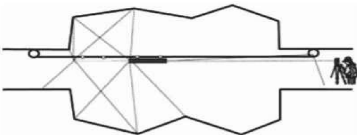
20 Сурет – Қиын қол жетпейтін кен қазбасын сканирлеу схемасы
